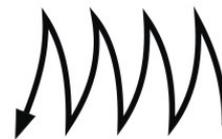
Прямые зигзагообразные движения применяют для получения наплавочных валиков при сварке встык без скоса кромок в нижнем положении и если нет вероятности прожечь деталь.
