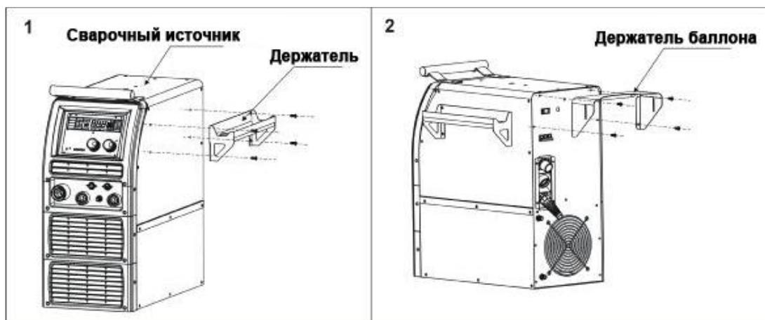
При эксплуатации без блока водяного охлаждения прикрепите тележку и механизм подачи проволоки к источнику сварочного тока 4 винтами М6 как на рисунках 3 и 4.
