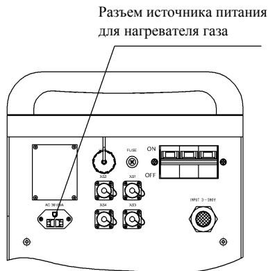
Рис. 6.16. Задняя панель источника питания (верхняя часть). Разъемы могут отличаться.
